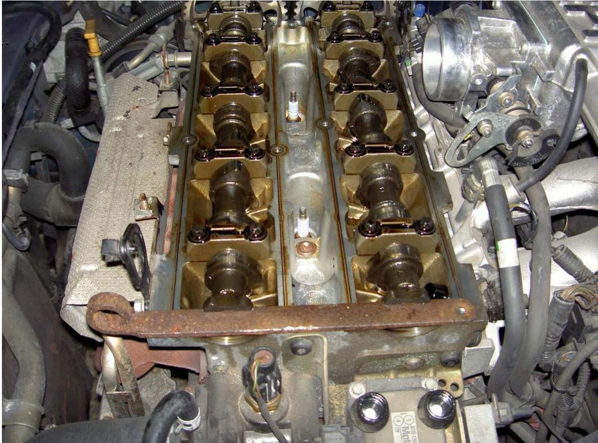
**Bild 2** blockierte Nockenwellen
