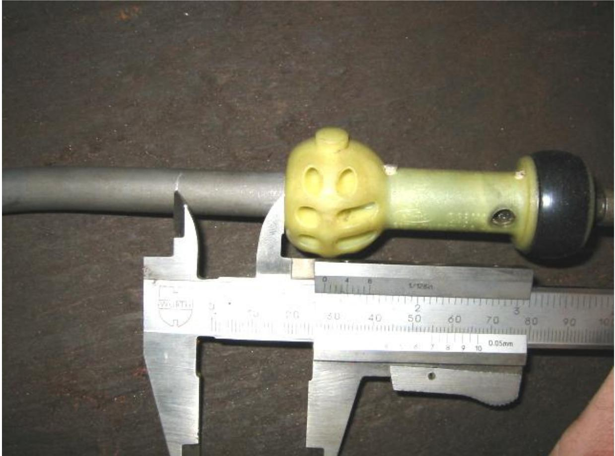
Jetzt wird die Plastik mittig zwischen den Kugeln durchgesägt (und lässt mir das Rohr ganz! ;-). Nun den Schalthebel gut in einen Schraubstock einspannen! Unten den Gummiring entfernt und einen 24er Ringschlüssel drüber gesteckt. Jetzt ordentlich auf den Schlüssel schlagen, bis die Kugel die vorher angerissene Markierung erreicht. Das geht echt schwer!
