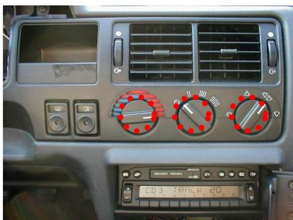
Hinter den 3 Drehreglern befinden sich noch weitere 3 Schrauben, die entfernt werden müssen. Die Regler kann man ganz einfach nach vorne weg abziehen.
