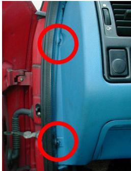
Zuerst sollte man die jeweils 2 Schrauben an den Seiten des Armaturenbretts entfernen.
