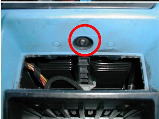
Im oberen Rahmen des Radio-Schachtes befindet sich 1 Schraube (Detailaufnahme im nächsten Bild). Links und rechts an der Rückseite des Kassettenschachtes befinden sich auch noch 2 Schrauben, die ebenso gelöst werden müssen.
