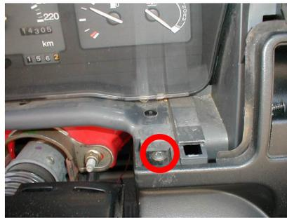
Um das Cockpit herauszunehmen, muss die Tachowelle abgenommen werden. Das Cockpit kann leicht herausgenommen werden, damit der Stecker (leicht zusammengedrückt) abgezogen werden kann.
